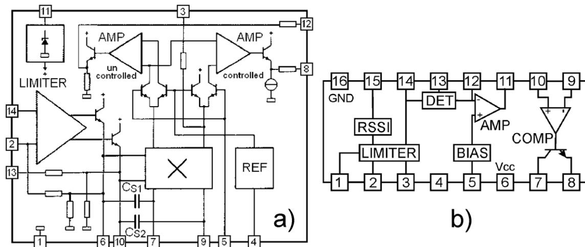
**Fig. 4** Inner structure a) TBA120U, b) TK14588V
